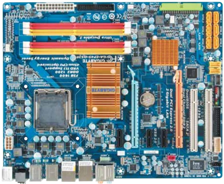
зовать в комплекте поставки. Рядом с дополнительными разъемами USB расположены целых шесть разъемов SATA2 для подключения жестких дисков. Правда, контроллера RAID в этой версии платы не предусмотрено.
