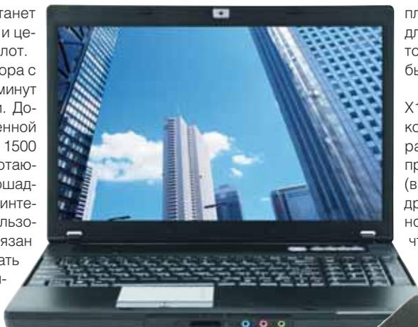
пластик, не сглаженные углы, клавиатура на всю доступную ширину без отдельных мультимедиа-кнопок по бокам. Чтобы как-то скрасить дизайн, на крышке «нарисован» фирменный логотип. Не забыта сияющая подсветка круглой кнопки включения/выключения, а также панель с 6-ю индикаторами (активность винчестера, интернет-сети и т. д.).
